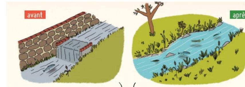
les poissons ne peuvent pas remonter en amont du seuil, les sédiments s'accumulent et l'eau se réchauffe.
